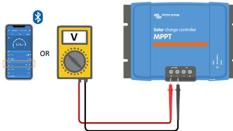
2. Mesurez la tension de la batterie sur les bornes de la batterie en utilisant un multimètre.
