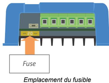
Retirez le fusible pour vérifier sa continuité. Si le fusible est défaillant, remplacez-le. Mais avant de mettre en place le nouveau fusible, vérifiez la polarité de la batterie, et résolvez le problème si la polarité est incorrecte.
