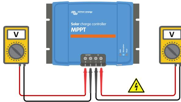
3. Comparé les deux tensions, la tension PV doit être à un niveau de 5 V supérieur à la tension de la batterie pour que le processus de charge continue.
