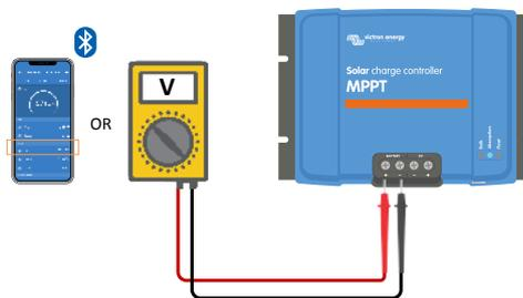
2. Utilisez un multimètre pour mesurer la tension sur les bornes de la batterie.
