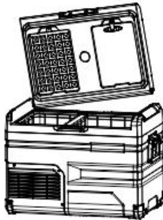
Richten Sie die Achse der Tür mit dem Loch auf einer Seite aus und stecken Sie sie ein.
